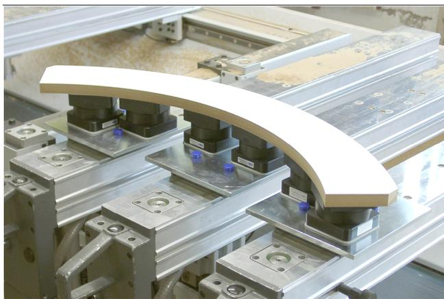
Adapter-Plates ISAP-K2 con Mono-Base e ventose per il fissaggio di componenti di legno
